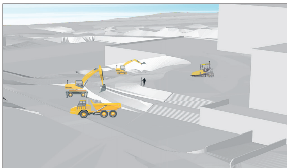
Bauliche Umsetzung mit dem DGM und der Maschinensteuerung
