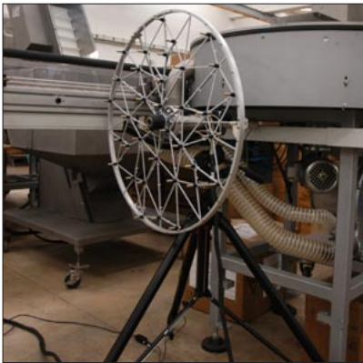
Mikrophon-Array, Akustische Kamera
