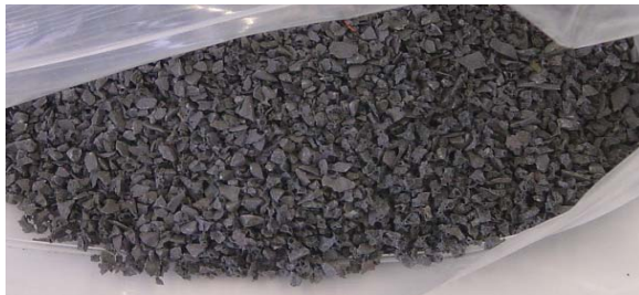
Eisen-modifiziertes Schaumglas in granuliertem Zustand
