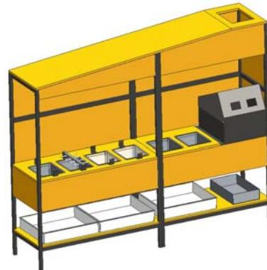
**Fertigung** Beim Dimensionieren des Tisches wurde festgestellt, dass an das Zinkbecken ( $450^{\circ}\text{C}$ ) besonders hohe Anforderungen gestellt werden. Deshalb wurde das Zinkbecken plus Heizung und Regelung bei einem Spezialisten angefertigt. Der Rest des Tisches wurde in Eigenarbeit erstellt.
