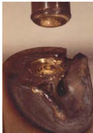
Dieses Bild zeigt eine Versuchsprobe von alten Versuchen, aus einem sehr schlecht brennbaren Stahl (Monel 400). Durch den Sauerstoff ist ein grosser Teil des Versuchskörpers innert Sekunden geschmolzen und verdampft
