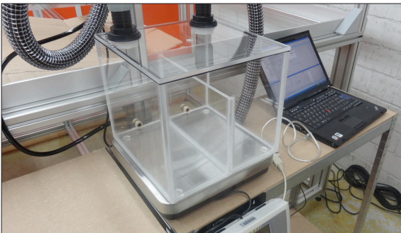
Selbst hergestellter Plexiglastank zur Wasserspeisung des Saugbalkens
