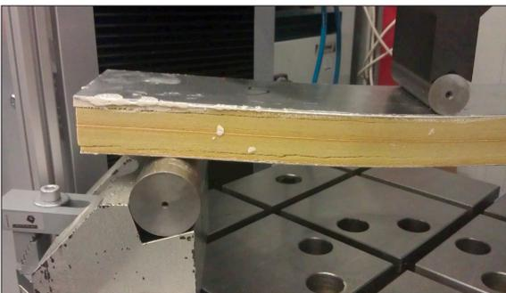
Abb. 2: 3-Punkt-Biegeprüfung der Sandwichprobe aus Aerowolle
