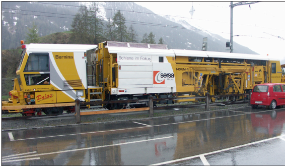
Die Meterspur-Gleisstopfmaschine B40UM-4 vor der Messung in Ardez-Scuol
