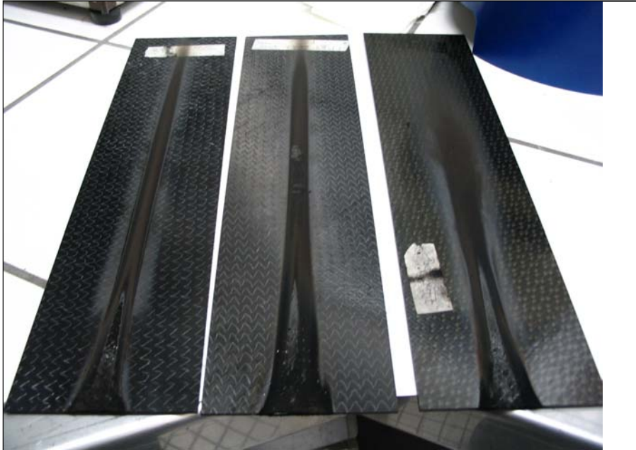
Flammentest-Harzsysteme im Vergleich nach Flammentest (v.l. RTM6 10%, LMbt 10% und Prepreg)
