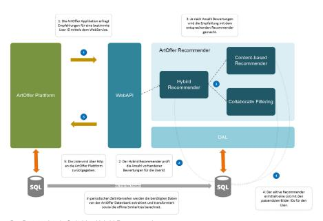
Der Prototyp ist ein Switching Hybrid-Recommender, welcher über ein Web API angesprochen werden kann.
