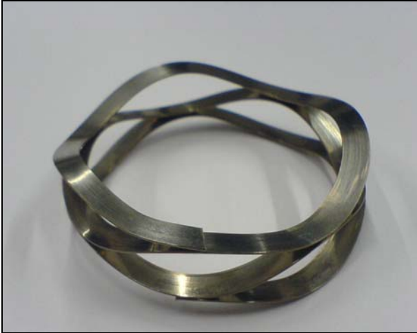
1) Foto einer Wellringfeder
