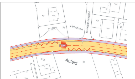
Situation der neuen Bushaltestelle inkl. Fussgängerstreifen mit Mittelinsel
