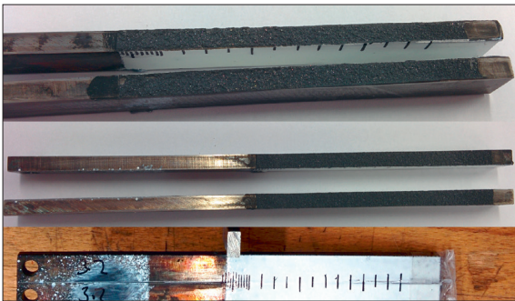
DCB-Prüfkörper: Unten verklebt, in der Mitte nach der Prüfung und oben Ansicht der kohäsiven Bruchfläche
