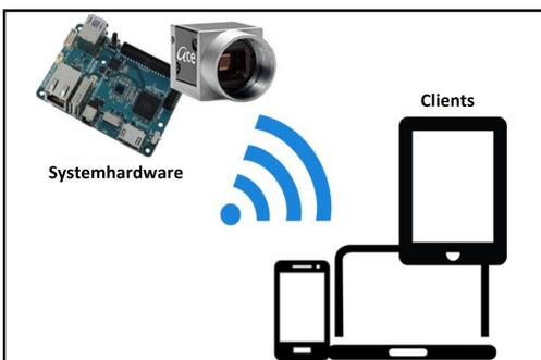
Beliebige Geräte verbinden sich mittels Webbrowser via WLAN mit dem Odroid-XU4, an welchen via USB 3.0 die Kamera angeschlossen ist
