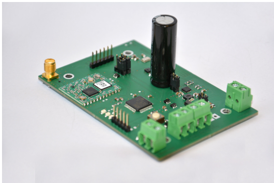
Sensorboard mit LoRaWAN Modul
