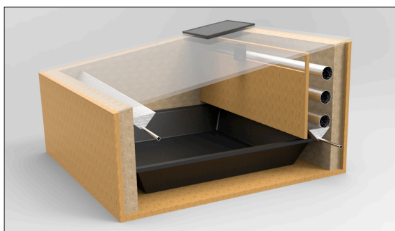
Schema der solaren Meerwasser-Entsalzungsanlage
