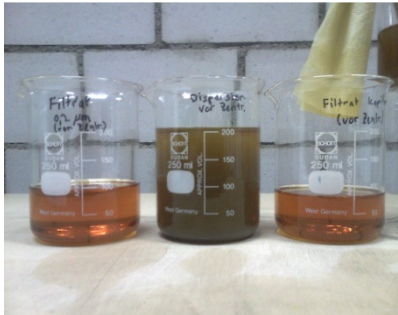
Gegenüberstellung der verschmutzten Dispersion (Mitte) und den gereinigten Flüssigkeiten mit Hilfe eines Mikrofilters (links) und eines Kapillar-Filters (rechts)
