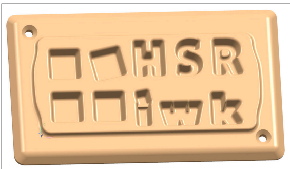
Negativwerkzeug für die Eiswürfelschale
