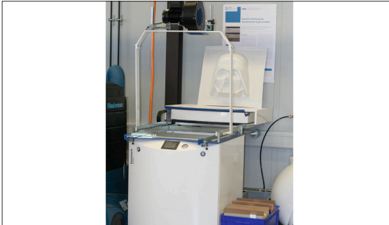
Thermoform-Einstationenanlage im IWK-Labor
