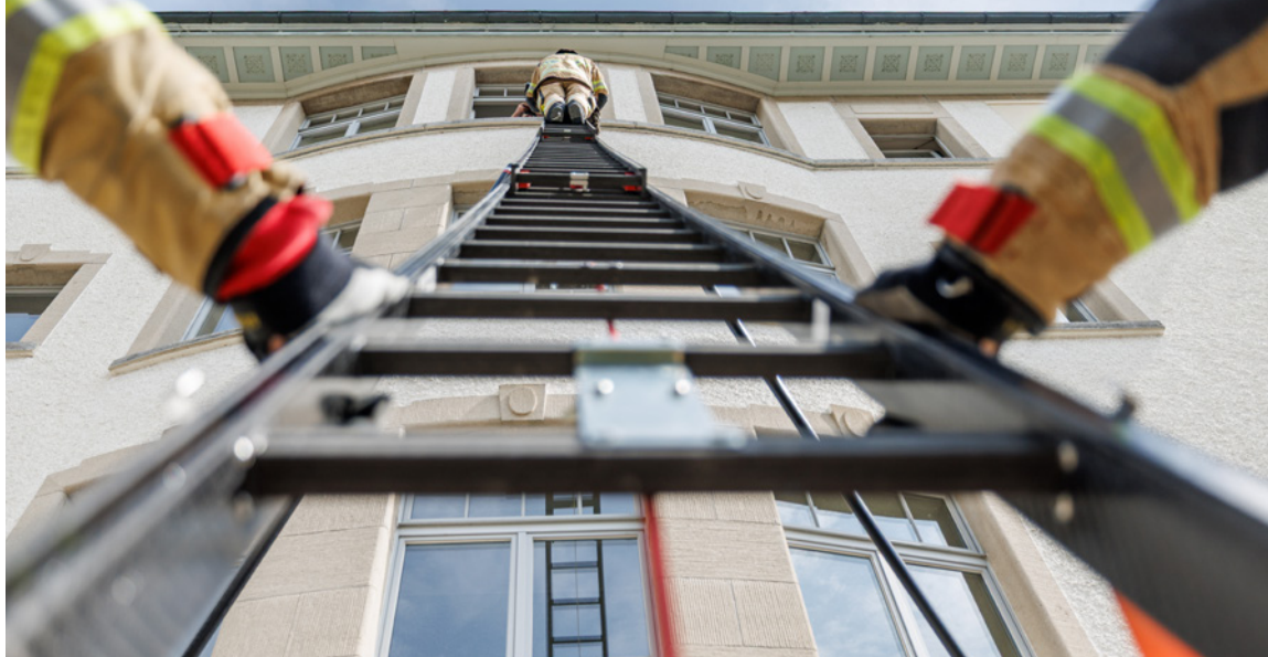
Stabile Sache: Die Carbonleiter schwankt auch unter Belastung kaum und erlaubt sicheres Arbeiten in bis zu 15 Meter Höhe
