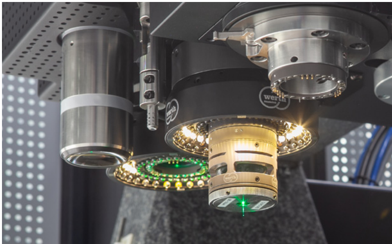
Mit einer ganzen Phalanx an Sensoren werden im Produktionsmesstechnik-Labor der OST Weltraumblenden exakt kalibriert und vor dem Einsatz funktionsgerecht gemessen.
