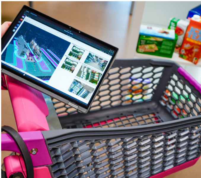
Auf dem Tablet ist zu sehen, wie der KI-Einkaufswagen seine Umgebung mit Kameras und Radar scannt und die Umgebung wahrnimmt.
