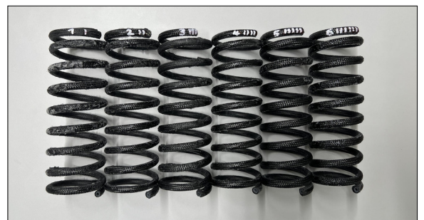
Hergestellte Prototypen aus CFK Eigene Darstellung
