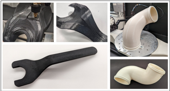
Bild 2: Links: Gabelschlüssel in der Herstellung mit Ablage der Endlofasern; Rechts: 5-Achs-gedrucktes Abflussrohr Eigene Darstellung
