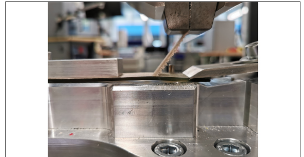
Aufgespritzter Tubus für Haftungsuntersuchungen (Zugversuch) Eigene Darstellung
