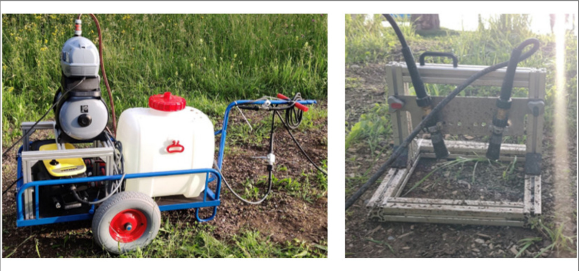
Realisierte Versuchsvorrichtung (links Wagen mit Wassertank, Hauswasserwerk und Hochdruckpumpe, rechts Düsenvorrichtung) Eigene Darstellung
