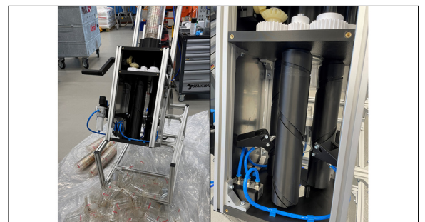
Erste Funktionsprüfung des "SpiralClean Feeders" mit CircCup-Bechern Eigene Darstellung
