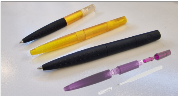
Abb.3: SLA gedruckte Kugelschreiber und Rendering inkl. Zukaufsteile Eigene Darstellung
