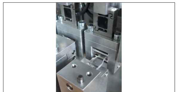
Krafteinleitung mit Sensoren und Probenaufnahme Eigene Darstellung
