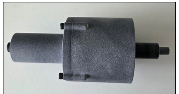
Erster SLS Aufbau zur Funktionsverifikation Eigene Darstellung
