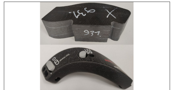
Wasserstrahlgeschnittener Vorformling (oben) mit Endbauteil (unten) Eigene Darstellung
