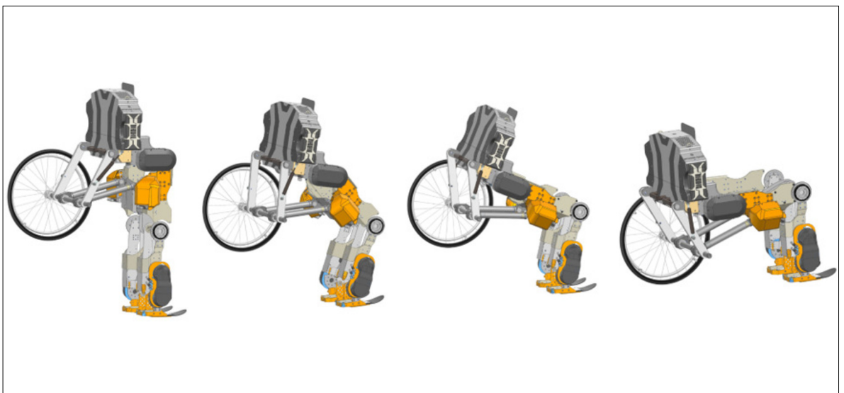
Moduswechsel vom Laufmodus in den Rollstuhlmodus mit Hilfe von Krücken (Rechtes Rad ausgeblendet) Eigene Darstellung
