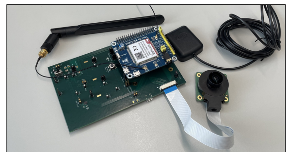
Abb. 2: Prototyp der entwickelten Leiterplatte (ohne Akku-Anbindung; CM4-Modul befindet sich auf der Board-Rückseite) Eigene Darstellung
