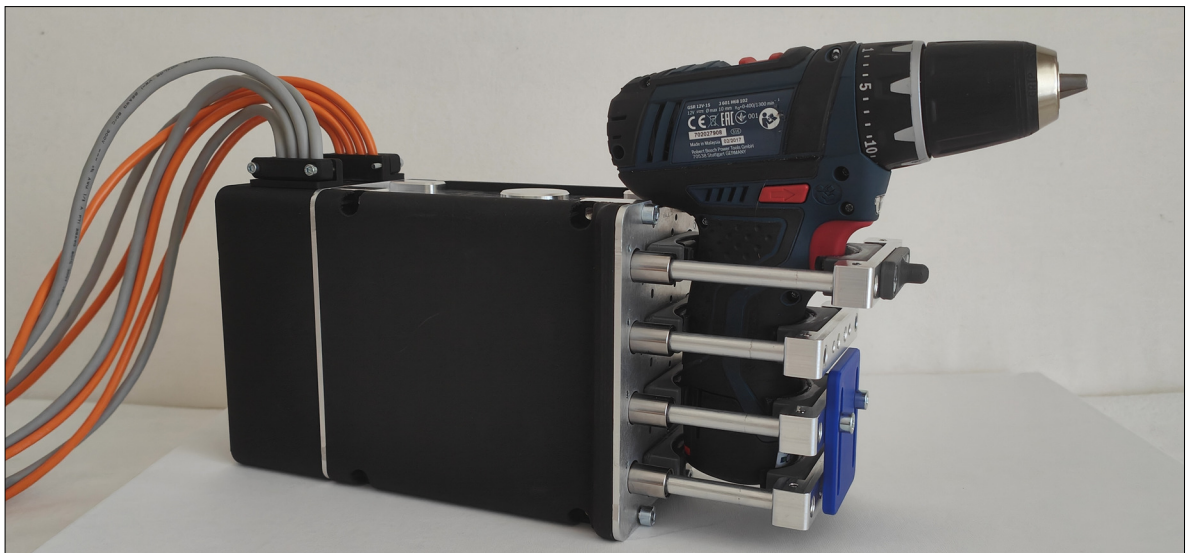
Prototyp des Greifers mit Akkuschauber Eigene Darstellung
