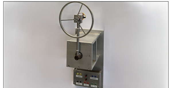
Laborsystem: Inverses Schwungradpendel Eigene Darstellung
