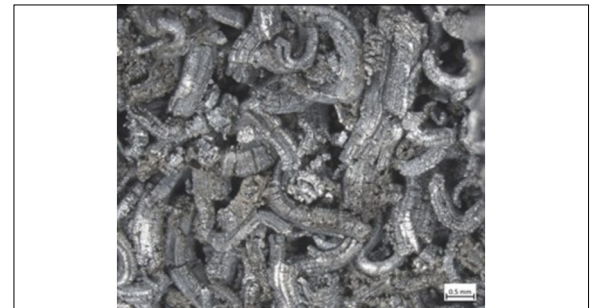
Mikroskopie Aufnahme einer intumeszierten Proben Eigene Darstellung
