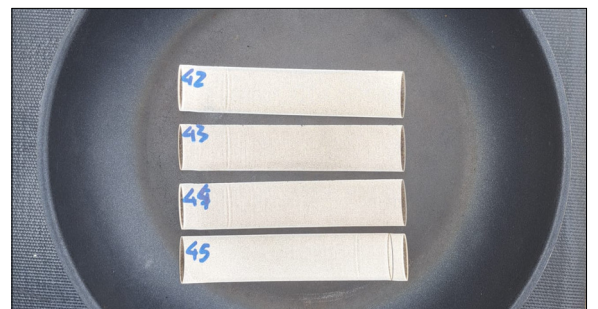
Ergebnis eines Reinigungsversuchs – PTFE-Beschichtung wurde mithilfe des Lasers vollständig entfernt. Eigene Darstellung
