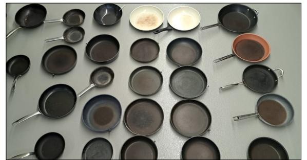
Pfannenproben mit unterschiedlichem Verschmutzungsgrad zur Bewertung der Reinigungsparameter. Eigene Darstellung
