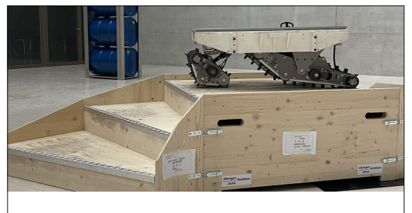
Entwickeltes Proof of Concept des Raupentrikes mit Hindernis der Wendeltreppe Eigene Darstellung
