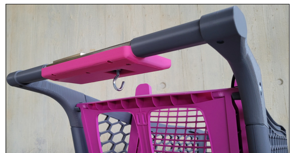
Detailansicht der Wiegeeinheit mit Lastaufnahme in Form eines Haken zur Aufnahme von Obst und Gemüse Eigene Darstellung
