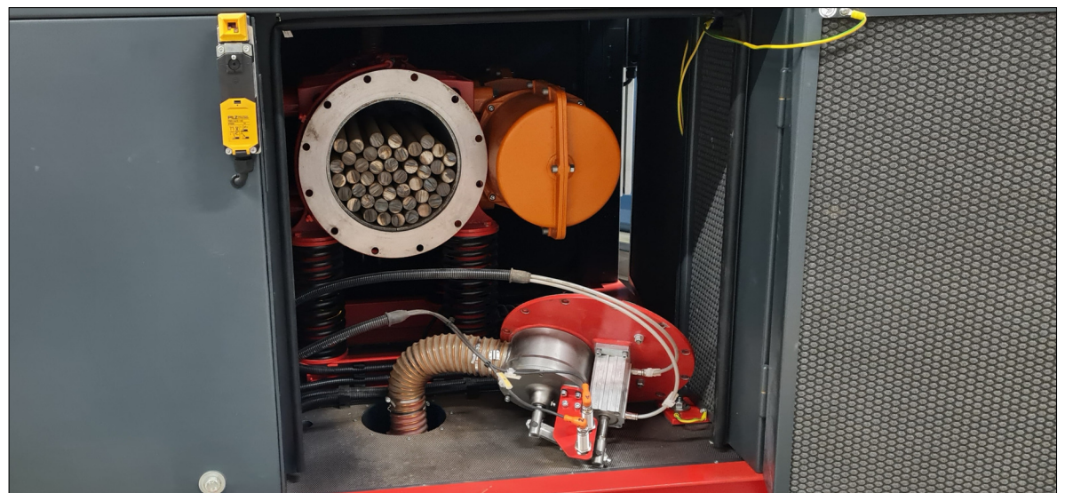
Schwingrohrmühle für die Zerkleinerung der KVA-Schlacke. Die Mühle ist mit Mahlstäben gefüllt. Eigene Darstellung
