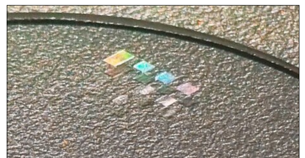
Beugungseffekt von reflektiertem Sonnenlicht an mehreren rechteckig angeordneten, ablatierten Kavitäten Eigene Darstellung
