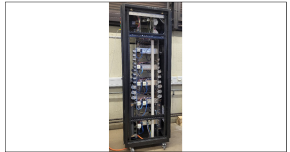
Lastschrank mit 14 Widerständen pro Aussenleiter Eigene Darstellung
