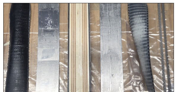
Ergebnis der Trennung der Hauptkomponenten: Metalle; Holzkern; Verstärkungsschichten; Seitenkanten Eigene Darstellung
