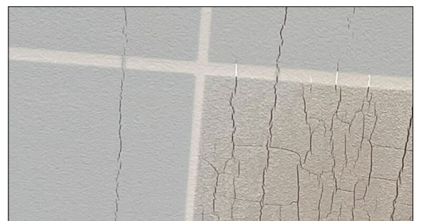
Risse in PA-Rückseitenfolie, hohe Rauheit durch Kreidung (Chalking) und Verbrennung einer einzelnen Zelle. Eigene Darstellung
