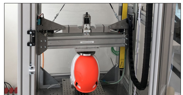
Abbildung 3: Nullpunktaufnahme am Helm Eigene Darstellung
