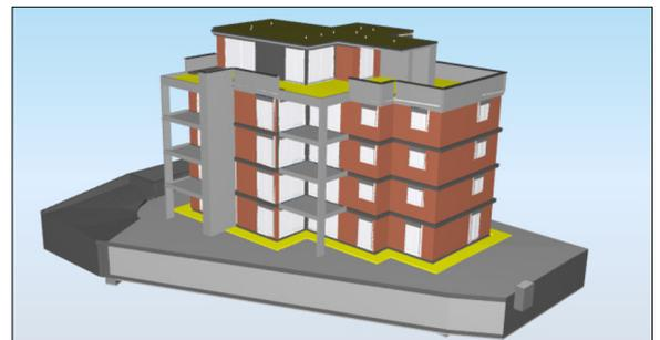
Erstelltes Analysemodell mit SCIA AutoConverter (Umwandlung IFC- zu SAF-Format)
