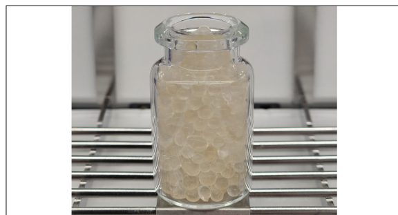
Wiegen des Silica Gels für die Quantifizierung des Massezuwachs Eigene Darstellung
