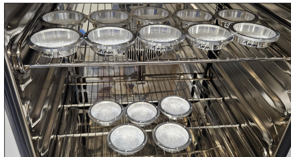
Trocknung des Silica Gels im Laborofen Eigene Darstellung
