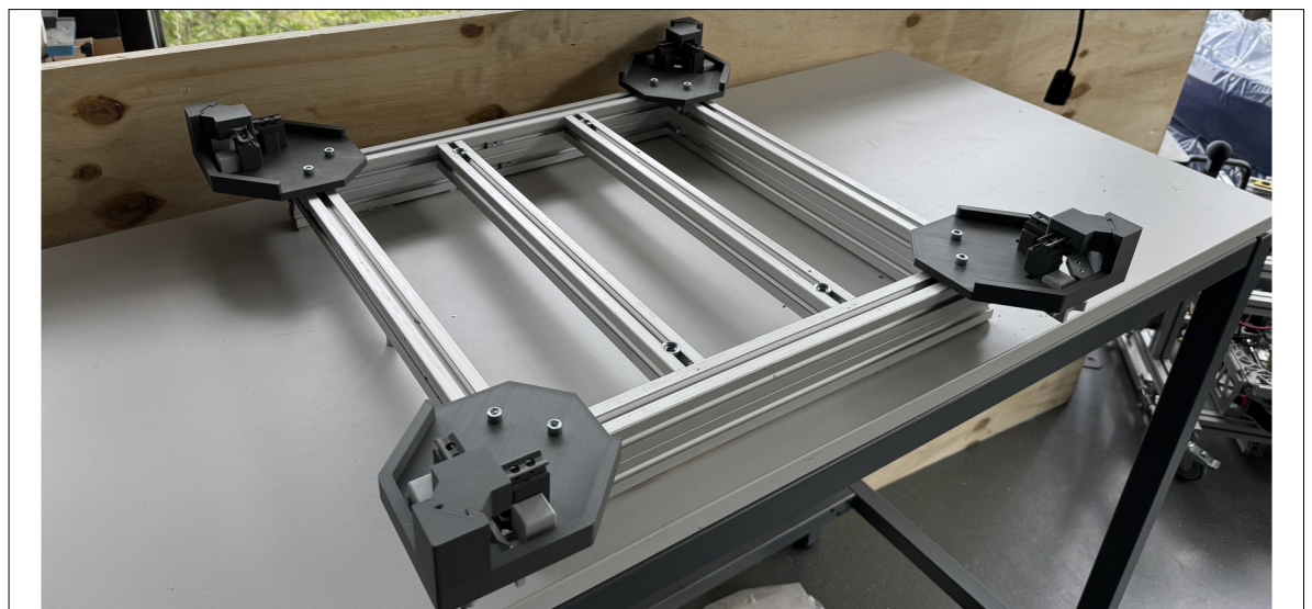
Funktionsmuster der Schweissanlage mit vier identischen Schweisseinheiten m. montierten Deckeln als geometrische Führung Eigene Darstellung
