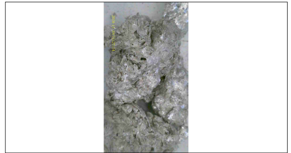
Probe, bestehend aus Gallium, Galliumoxid und Kohlenstoff Eigene Darstellung
