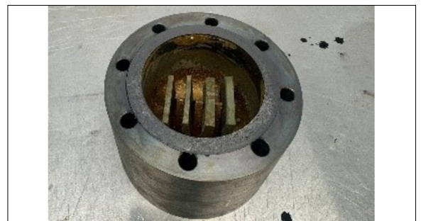
Proben und Prüfstand nach dem zweiten Versuchsdurchgang mit 350°C, in HCl-Umgebung und Versuchsdauer von 168h Eigene Darstellung
