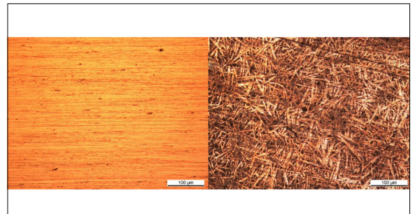
Aufnahme unter Mikroskop von einer Inconel 625 Legierung, links vor dem Versuch, rechts nach dem Versuch Eigene Darstellung
