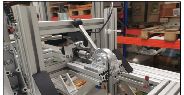
Spannvorrichtung des Auslösemechanismus für die Schwingungsmessung Eigene Darstellung
