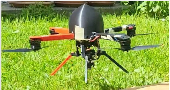
Abschusstest mit Ausklappen der Arme und Füsse Eigene Darstellung
