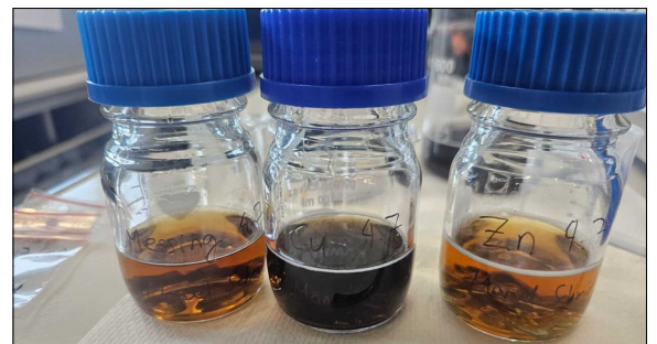
Abb. 2: Passivierung der Metallpartikel Eigene Darstellung
