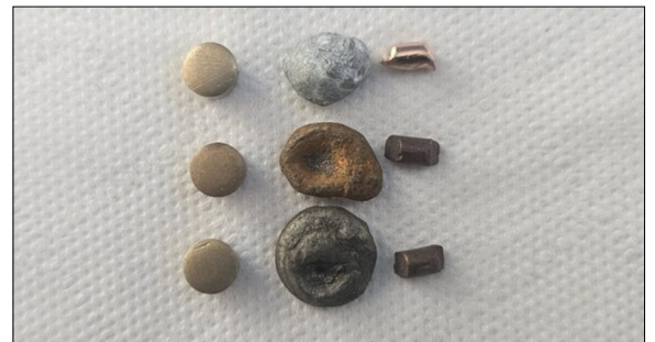
Abb. 1: Messing-, Zink- und Kupferpartikel unbehandelt (oben) und nach der selektiven Behandlung (mittig und unten) Eigene Darstellung
